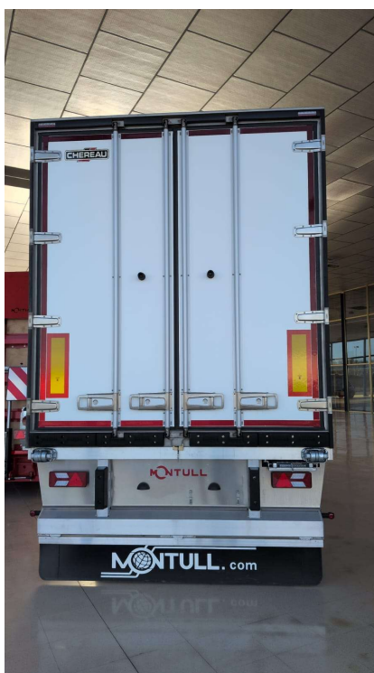
Parte trasera de la unidad fotografiada: puertas, barras de cierre y protecciones.
