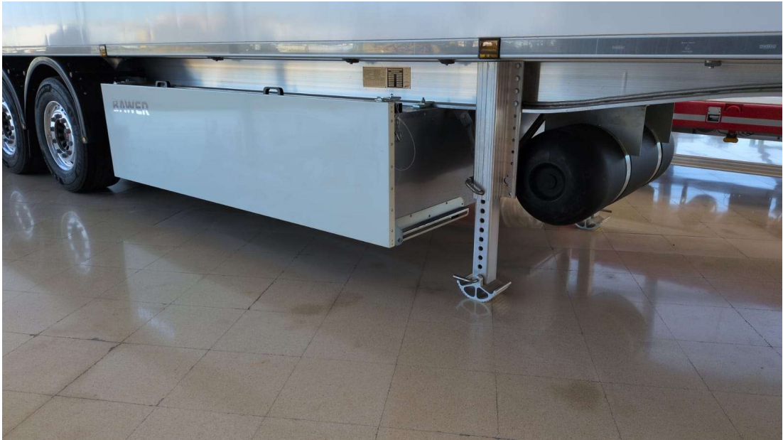
Lateral inferior: portapalés BAWER, patas de apoyo y depósitos visibles.
