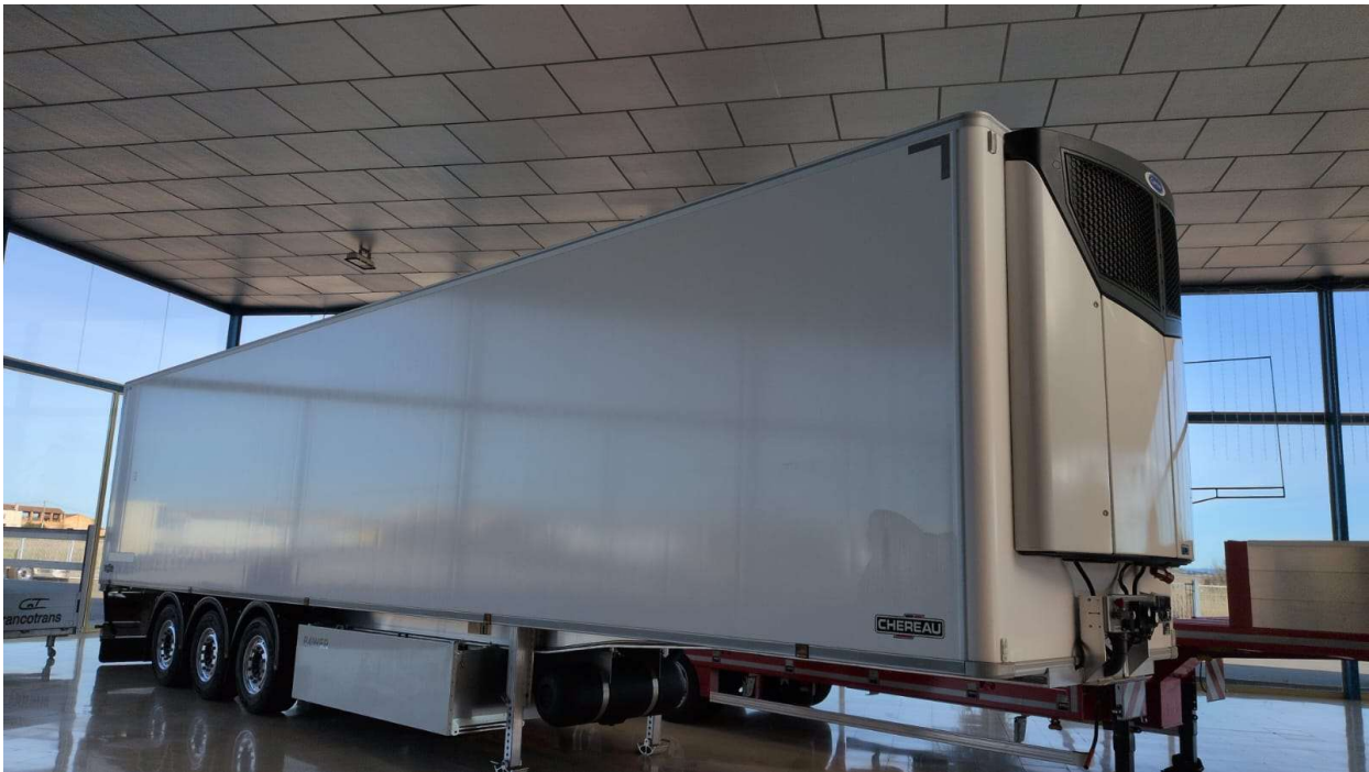
Semirremolque frigorífico CHEREAU INOGAN para transporte de carne colgada, sobre chasis integral de aluminio.
